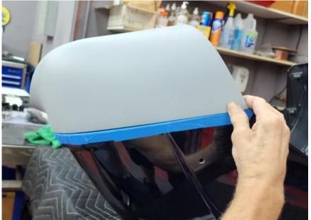
USE A STRAIGHT EDGE MARK ALIGNMENT NEEDED AND TRIM EDGE TO FIT.
