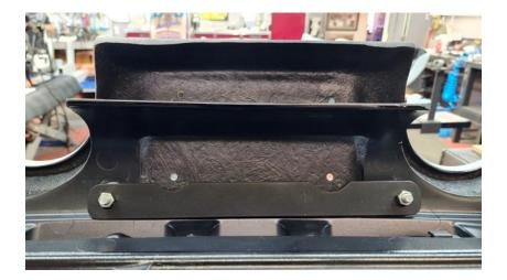
THIS SHOULD KEEP THE EDGE OF THE ROLL PAN AGAINST TRUNK EDGE. PUSH ONE SIDE OFF ROLL PAN DOWN AGAINST THE EDGE OF TRUNK WHILE ALSO PUSHING CORNER DOWN. A SLIGHT TWIST IS REQUIRED IF THE FRONT EDGE OF THE ROLL PAN DOES NOT ALIGN WITH TRUNK EDGE.
