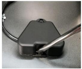
POP CONNECTOR LOOSE FROM THE HOLD DOWN CLIPS & DISCONNECT CONNECTOR.
