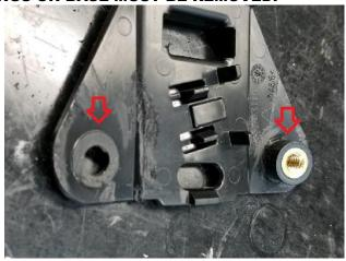
CUT THE PLASTIC AROUND INSERT AT THE BOTTOM & REMOVE INSERT.
